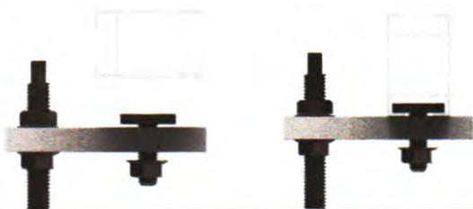
O perfil smart tem forma "espelhada" então poderá ser fixado ao parafuso cabeça-martelo independente do lado .
