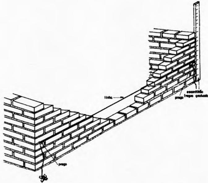
Figura 2 - Detalhe do nivelamento da elevação da parede.
